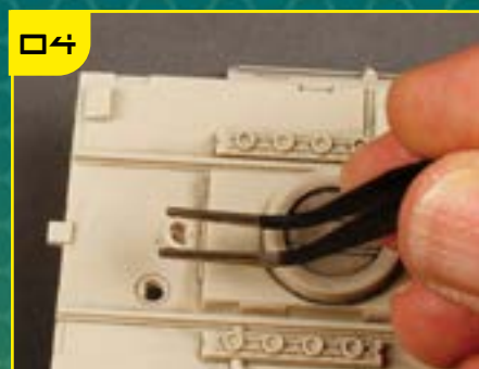
Вклейте деталь 3 в отверстие во фрагменте TP-18. D-образная форма углубления позволяет установить деталь только в одном положении.
