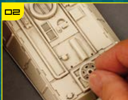
Приклейте деталь 1 к фрагменту TP-18. D-образная форма углубления позволяет установить деталь только в одном положении.
